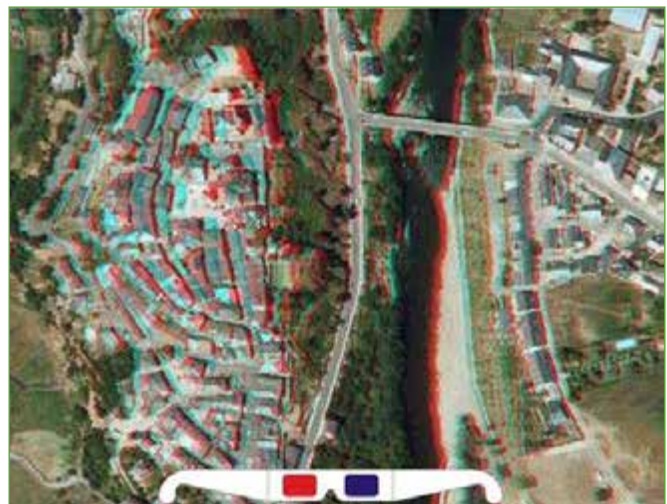
Figura 3. Anaglifo creado empleando el par de fotografías que cubren la zona de interés
