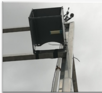
Figura 10. Captador passiu instal·lat a la Unitat Mòbil
