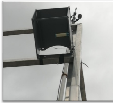
Figura 9. Captador passiu instal·lat a la Unitat Mòbil
